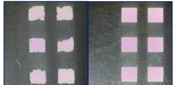
Schablone vor der Reinigung mit dem Gensonic
